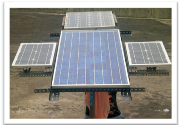
GAMBAR 1: Skema rancang bangun pemanfaatan modul surya monocrystalline di FMIPA UNJ
